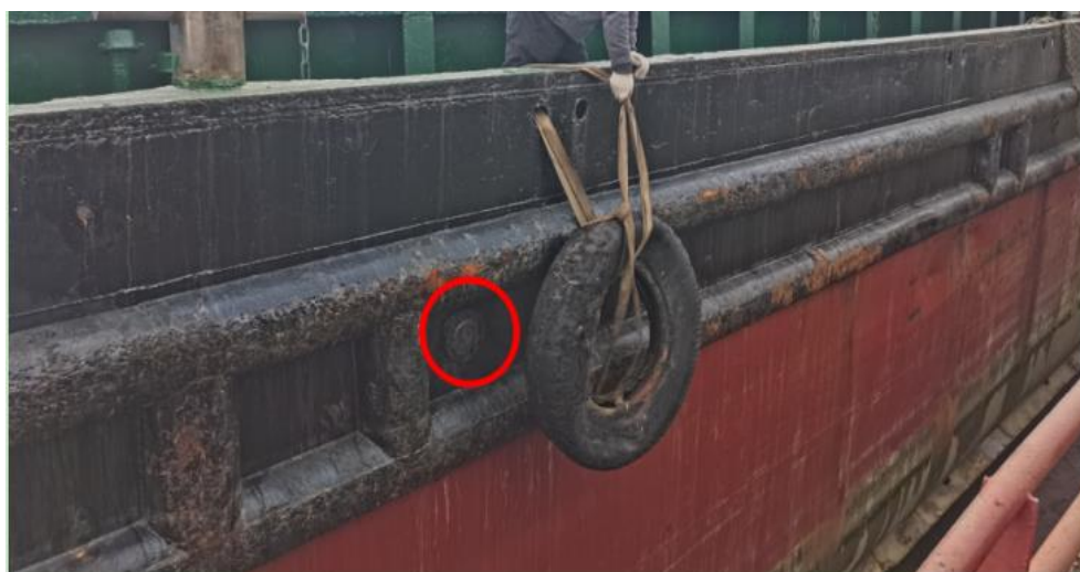
图 8：船首主甲板左舷第 1 个排水孔侧视图
