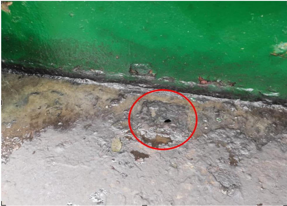
图 9：船首主甲板左舷第 1 个排水孔俯视图
